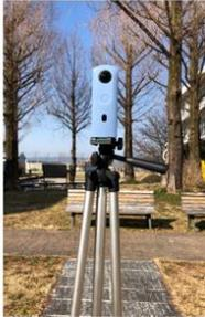
360°動画撮影用カメラ「RICOH THETA SC」三脚を立てて撮影ボタンを押すだけで、360°動画と360°画像が撮れる。周囲の自然音なども録音できる
